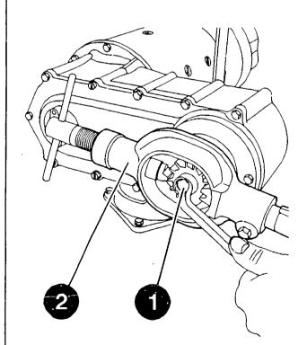
DISASSEMBLING 4-SPEED REDUCTION GEAR (TYPE TF 0 001 6....)
